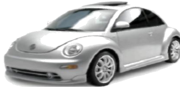
VW New Beetle, 2005, 1200 kg, 75 PS, 160 km/h, 7,1 l/100km
